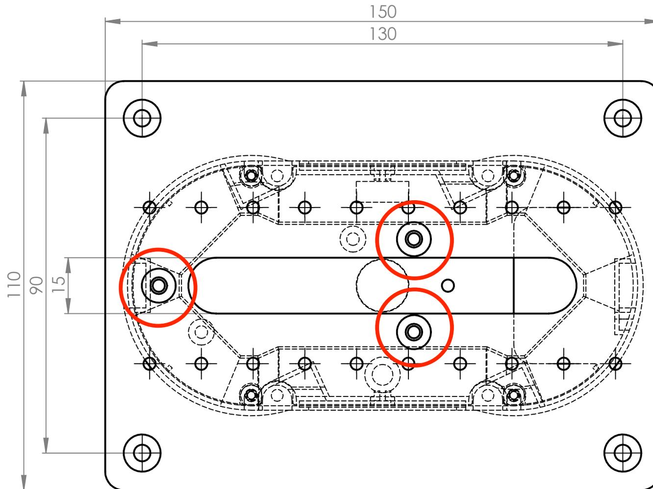
Für die Montage mit dem viveroo MontageSet Inwall, befestigen Sie die Adapterplatte über die drei markierten Löcher auf dem MontageSet.
